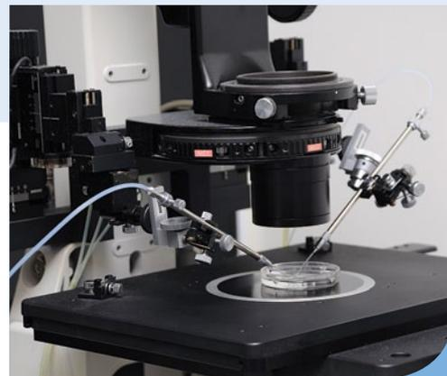
Placa de cultura no microscópio pronta para realização da ICSI (injeção intracitoplasmática).
